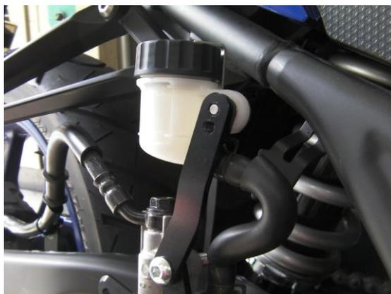
リザーバタンクとタンデムステップブラケットが干渉する場合、タンデムステップブラケットを外すか、⑩リザーバタンクステーを裏返し、②ステッププレートのもたがって右側の面に取り付けてください。その際ナットは使用しません。リザーバタンクはステーのもたがって左側の面に左側からボルトを通して固定します(画像1)。リザーバタンクが傾き、フルードがにじむ恐れがある場合はタンク内のフルードを少量抜き、漏れないように注意してください。
