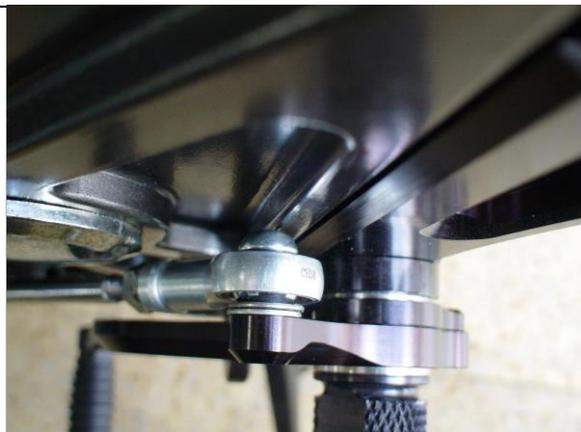
3、タンデムステップをステッププレート後端に取り付ける(純正ナット使用)。
