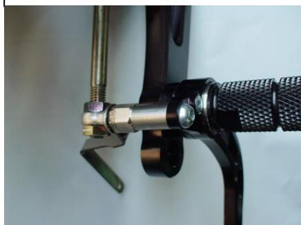
6、ステップバーを本締めした後、本体を⑨カラーを挟んで車体に取り付ける。その後スプリングフック先端にブレーキスイッチスプリングを引っ掛ける。
