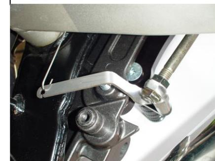
7、ステッププレート後端に純正タンデムステップを取り付ける。
