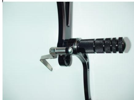
4、マスターシリンダーのプッシュロッド先端に⑦トルクロッドピンを仮組みする。純正ロックナットx2を流用し、⑦の先端にグリスを塗布する。
