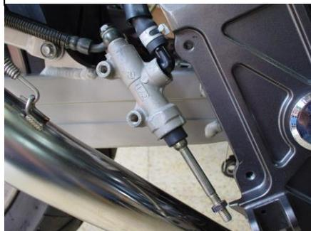
3、ブレーキペダル後端に⑧スイッチスプリングフックを仮組みする。⑮ボタンボルト M6x15 を使用すること
