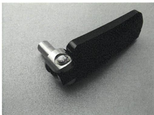
純正ステップから外しておいたピン・板バネ・クリップを使用してキット内のペグを組み立てます(左右分)
